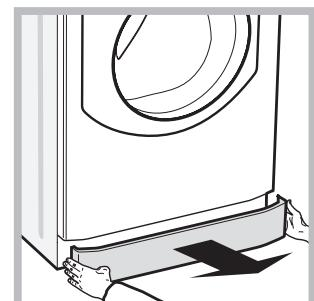
1. зніміть захисну панель з передньої частини машини шляхом натискання у центрі, потім натисніть униз з обох боків та витягніть її (див. малюнки).
